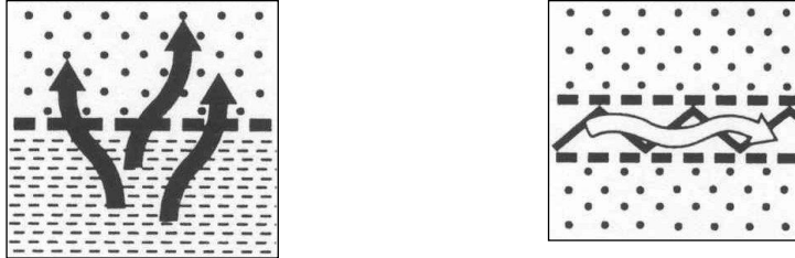
Slika 3: Shematski prikaz razlike v delovanju filtrskega (levo) in drenažnega geosintetika (desno).
